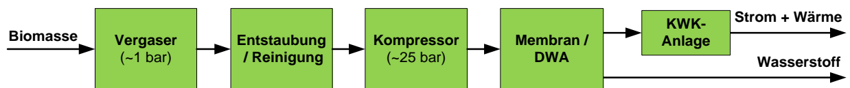
Abb. 10 Blauer-Turm-Konzept zur Polygeneration
