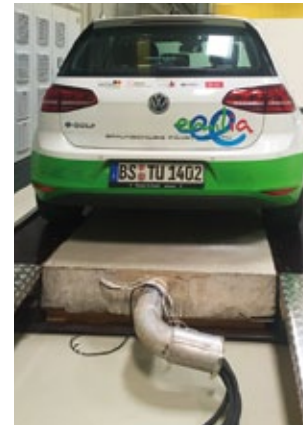
Abbildung 33: Induktive Ladung von Pkw im Labor
