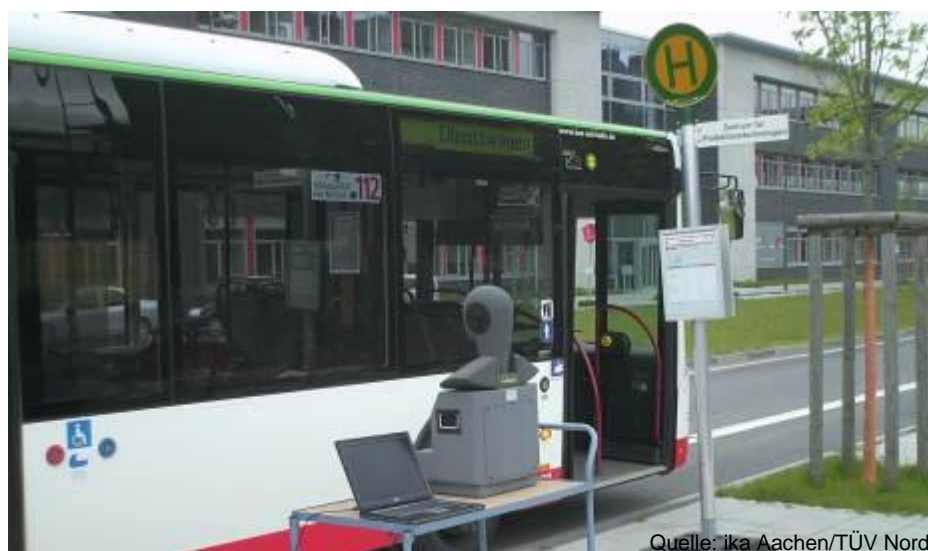
Abbildung 18 Einsatz des Kunstkopfmesssystems an einer Haltestelle
